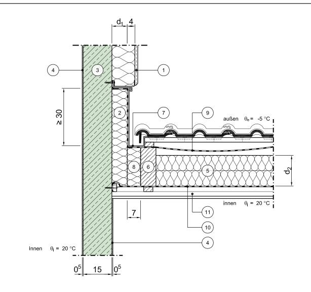
Vertikalschnitt Maßstab 1:10
