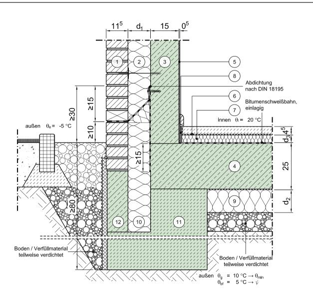
Vertikalschnitt Maßstab 1:10
