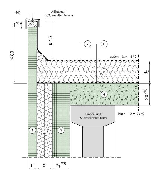
Vertikalschnitt Maßstab 1:10
